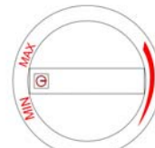
Position Ein Position MIN > minimale Leistung Position MAX > maximale Leistung
